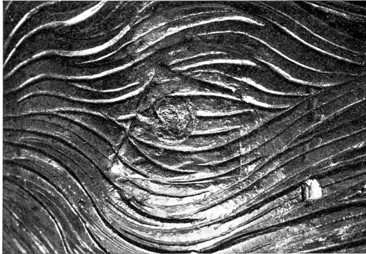
Abb. 6. Plattierung und Ansatz des Eisenstabes auf dem Scheitelpunkt
