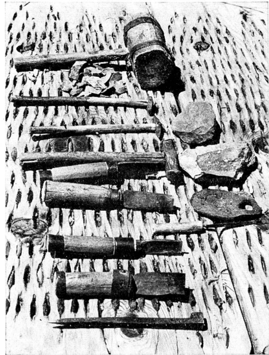
Abb. 10. Die zur Reparatur von Dreschschlitten verwendeten Materialien und Werkzeuge auf einem Dreschbrett ausgelegt (Beschreibung und Bezeichnungen im Text S. 268)
