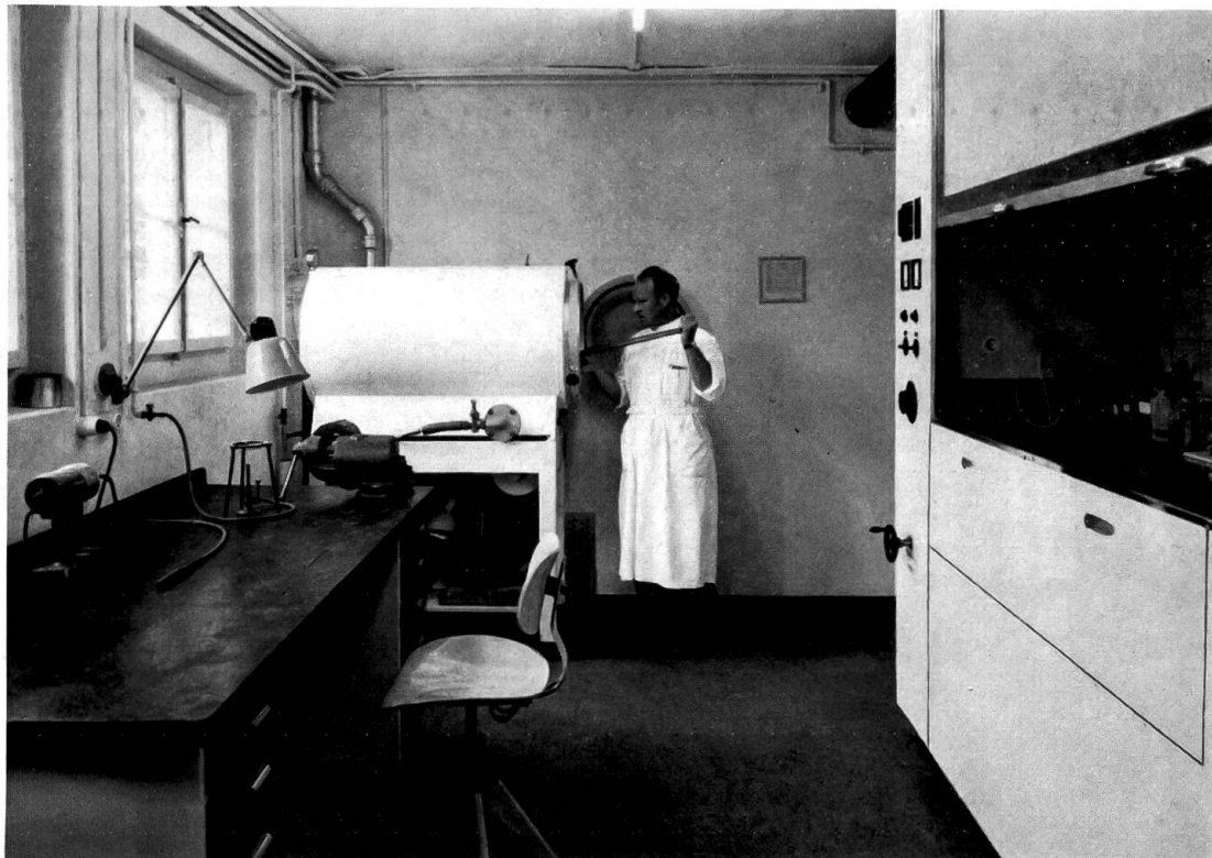
Historisches Museum, Einbau eines Laboratoriums 1957. Oben: Keramikraum mit Sortiertisch und Schubladengestellen. Unten: Metallraum mit Werkbank, Vakuum-Trocken- und Wärmeschrank und Kapelle.
