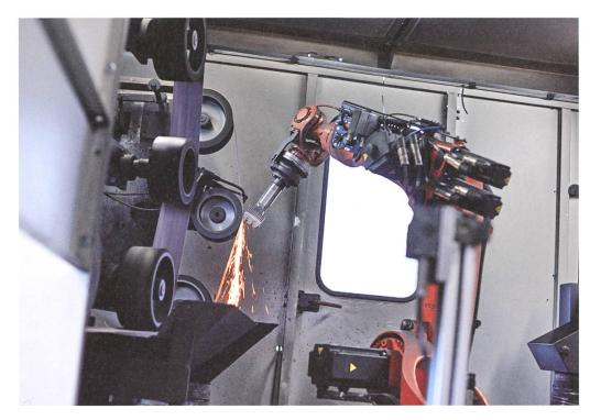
Hunderttausende von Messern werden jährlich geschliffen. Diese Arbeit ist schon längst den Roboterarmen übergeben worden.
