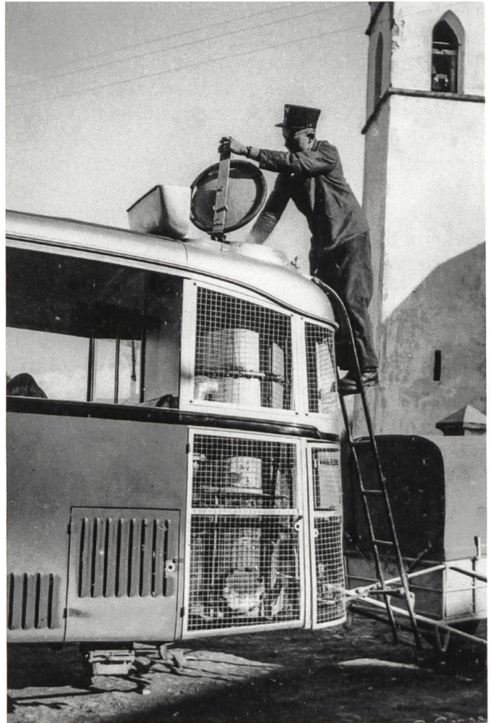
Holzvergaser sicherten während dem Krieg den Antrieb der Motorfahrzeuge.
