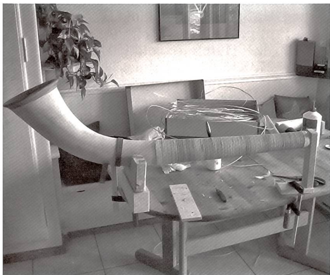
Das Alphorn wird mit 4 mm breiten Peddigrohrschienen umwickelt.
