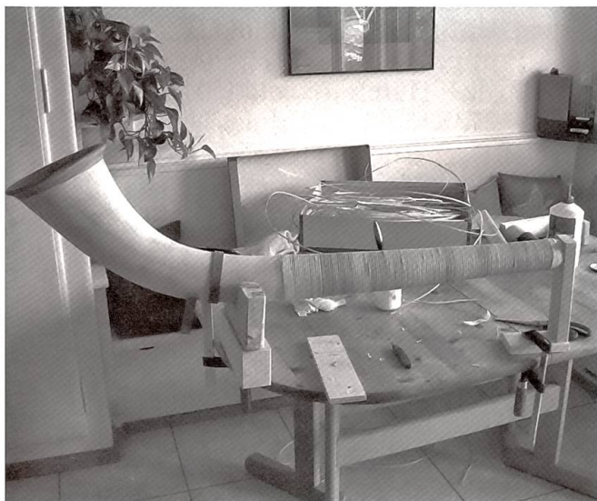
Das Alphorn wird mit 4 mm breiten Peddigrohrschielen umwickelt.
