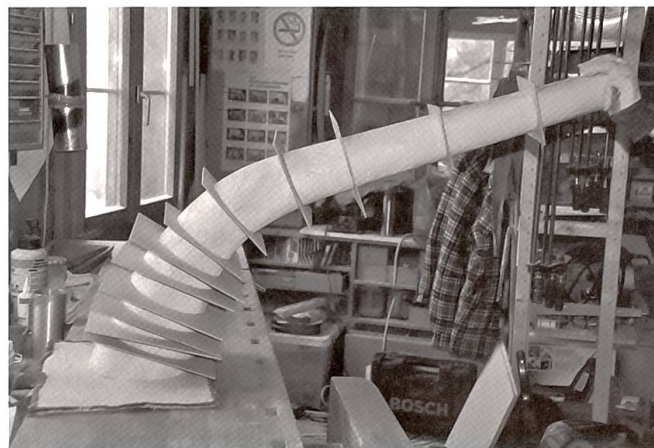
Mit Kartonschablonen wird die äussere Form des Bechers überprüft und diese wo nötig nachbearbeitet.
