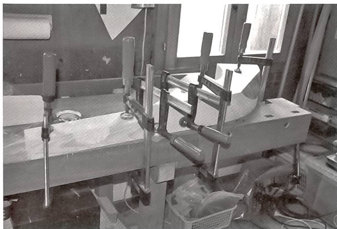
Das Bechervorderteil wird mit dem Becherendteil fest verleimt.
