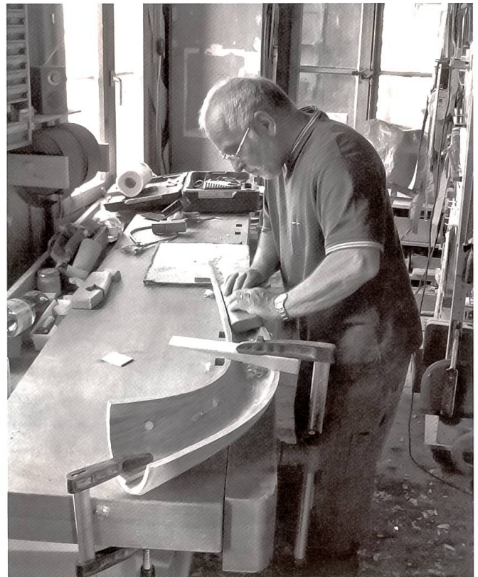
Die Innenseite des Bechers wird mit speziellen Hobeln bearbeitet und mit der Becherform angepassten Schleifklötzen geschliffen.
