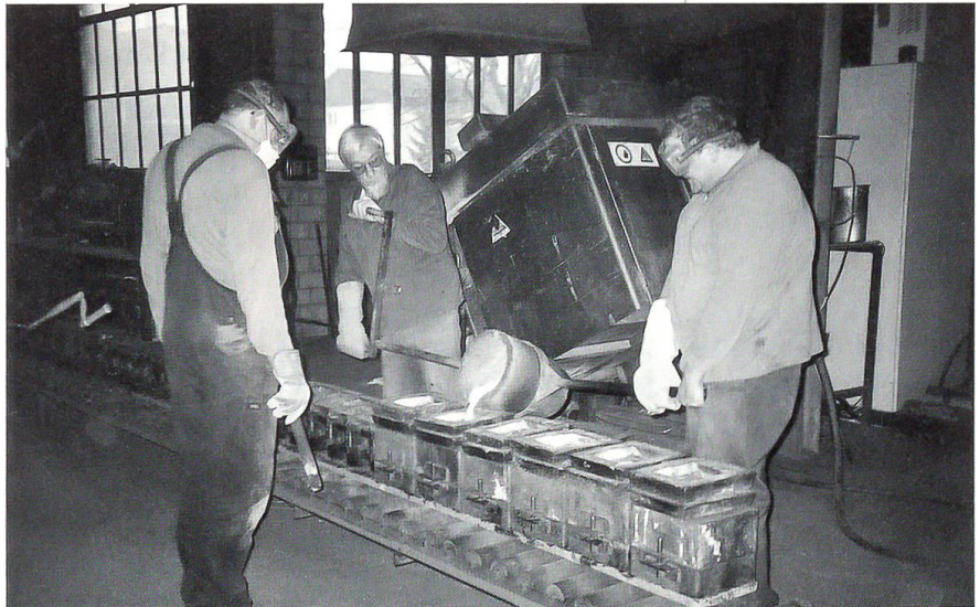
Einfüllen des flüssigen Metalls in die Formen (Foto: Ernst Gyger)
