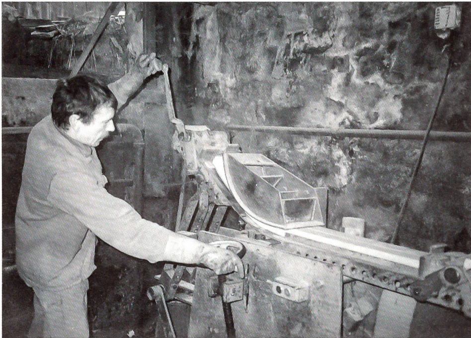
Die Holzkufen werden im erhitztem Zustand gebogen. (Foto Ernst Gyger)
