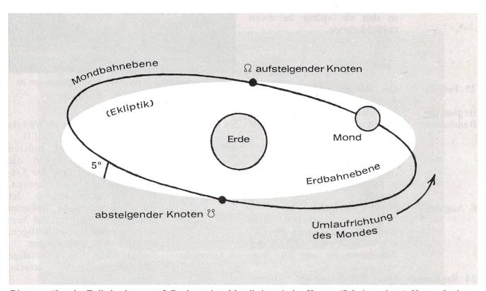
Die gegenüber der Erdbahnebene um 5 Grad geneigte Mondbahn mit den Knoten (Schnittpunkten). Vom aufsteigenden bis zum absteigenden Knoten bewegt sich der Mond oberhalb, anschliessend unterhalb der Erdbahnebene.
