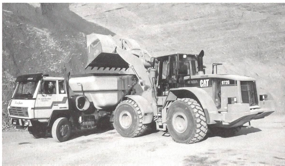
Kiesauflad mit dem Pneulader direkt auf Lastwagen
