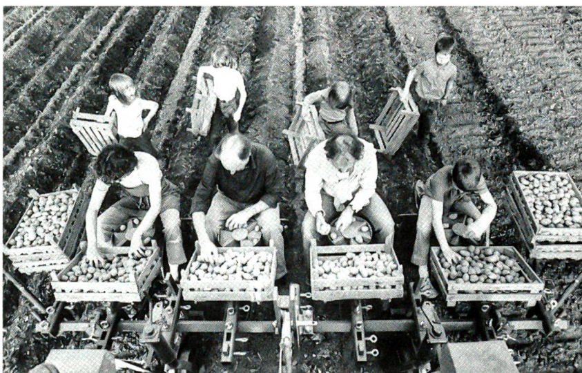
Kartoffeln am laufenden Band Halbautomatische Kartoffelsetzmaschine im Einsatz. (Photo Hansueli Trachsel, Bern)
