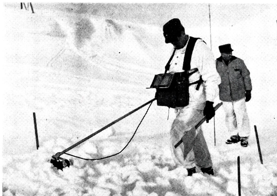
Hilfe für Lawinenopfer: Mit diesem neuartigen Suchgerät können Lawinenopfer mit großer Bestimmtheit gefunden werden, sofern sie einen kleinen Magneten auf sich tragen.
