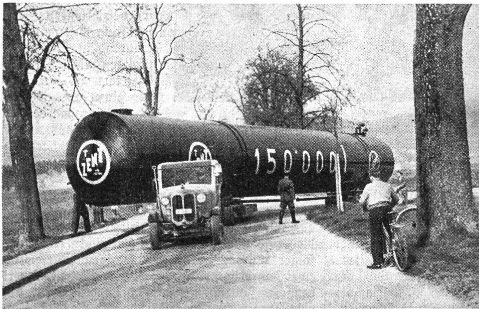
Öltank für die neue Rehrichtverbrennungsanstalt der Stadt Bern mit 150 000 Liter Inhalt
