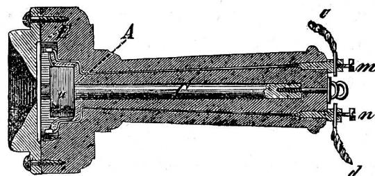
A ist der Kern aus weichem Eisen, a sind die Drahtwindungen um denselben. Die beiden Enden dieser Windungen sind an die Klemmen m und n gelötet und von hier gehen dann die beliebig langen Drähte c und d nach dem andern Telephon ab. C ist der Magnet und E die schwingende Eisenplatte hinter der Schallöffnung und in unmittelbarer Nähe vor dem Eisenkern. Alles Uebrige bildet die Schale, welche die wirksamen Theile des Telephones umhüllt.
