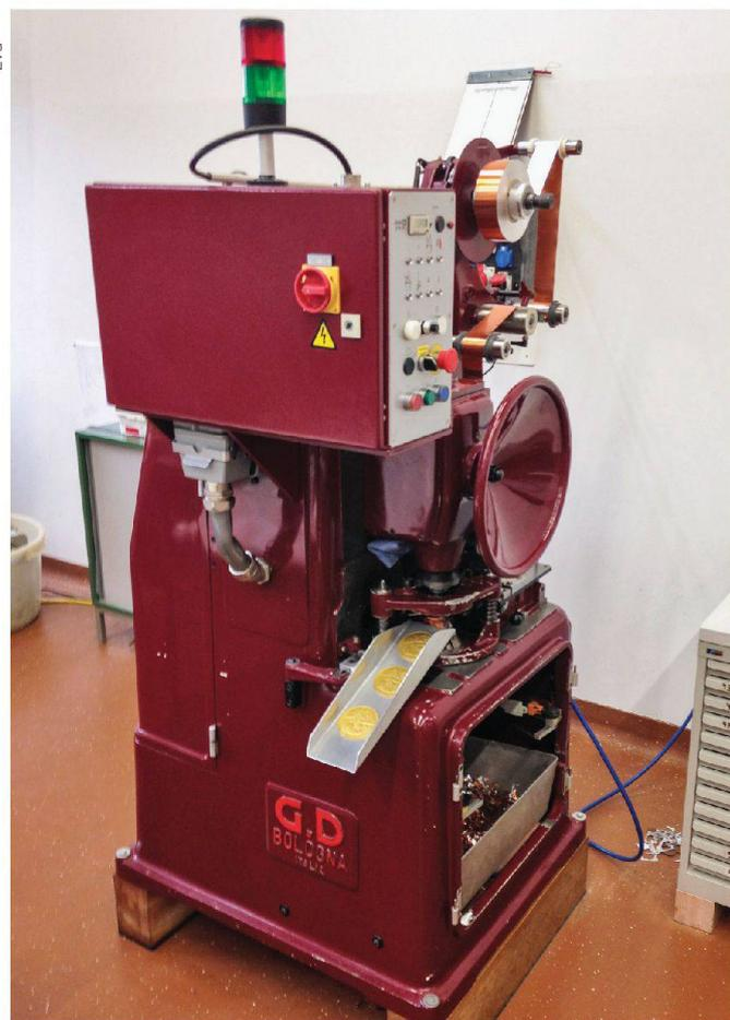
*Die Prägemaschinen waren schon bei der Herstellung der ersten Schoggitaler 1946 im Einsatz.*
