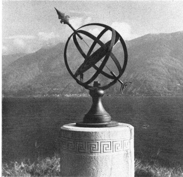
Auf einer Gartenterrasse treffen wir eine seltene Äquatorialsonnenuhr mit Meridiankreis, Sechsstundenkreis und Tierkreisring. Der Pfeil weist zum Himmelspol. Gerne lesen wir auf ihr die wieder heller gewordenen Schicksalsstunden der Inseln ab. Sur une terrasse: Horloge solaire équatoriale et rose des vents, avec méridienne, sextant et zodiaque. La flèche indique le pôle céleste.
