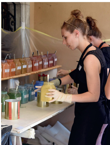
Peintures au silicate: les pigments de couleur sont mélangés avec le verre liquide au potassium.
