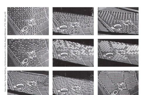
Maquettes d'étude de Marti & Trippel pour des indices d'utilisation de 0,5 (colonne de gauche), 0,75 (au centre), 1,0 (colonne de droite)
