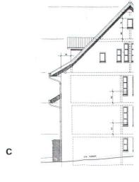
Ferme à Röschenz BL: A= façade N/O avant transformation, B= projet de transformation du maître de l'ouvrage, C= solution proposée par le conseiller technique (Matthias Herzog). L'intervalle des fenêtres est en rapport avec le projet de transformation.
