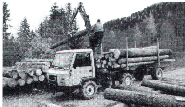
Mit der Anschaffung eines Spezialfahrzeuges für den Abtransport des Holzes konnte bei San Bernardino der Bau einer aufwendigen Lastwagenstrasse vermieden werden. (Bild FLS)
