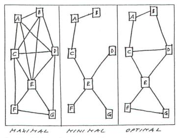
Drei Möglichkeiten Strassennetzprobleme zu lösen und mehrere Siedlungspunkte miteinander zu verbinden: v.l.n.r. die Maximal-Variante mit der grössten Bodenbeanspruchung, die Minimal-Variante mit dem kleinsten Flächenbedarf und die Optimal-Variante. (Bild NFP 22)
