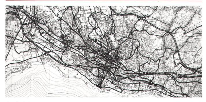
Oben: Der Verkehrsrichtplan für die Region Lausanne beruht auf einem System radialer Ausfallstrassen und ringförmig angelegter Verbindungsstrassen. Rechts: Dabei wird beabsichtigt, das Stadtzentrum in zunehmendem Masse von einem Teil des Privatverkehrs zu entlasten und das öffentliche Transportnetz auszubauen.
