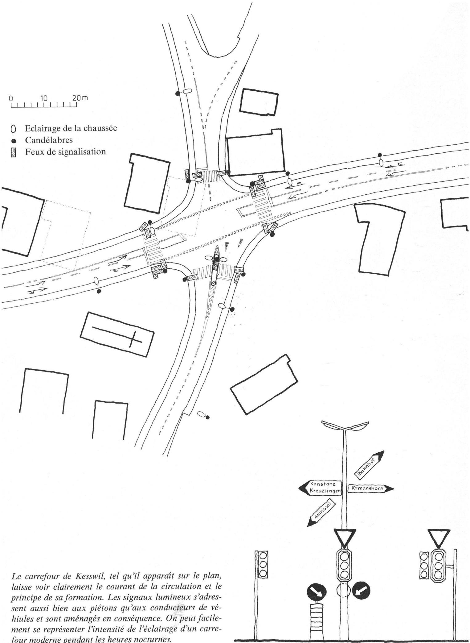
*Le carrefour de Kesswil, tel qu'il apparaît sur le plan, laisse voir clairement le courant de la circulation et le principe de sa formation. Les signaux lumineux s'adressent aussi bien aux piétons qu'aux conducteurs de véhicules et sont aménagés en conséquence. On peut facilement se représenter l'intensité de l'éclairage d'un carrefour moderne pendant les heures nocturnes.*
