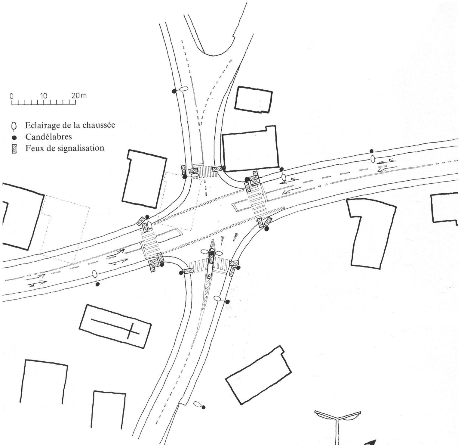
Le carrefour de Kesswil, tel qu'il apparaît sur le plan, laisse voir clairement le courant de la circulation et le principe de sa formation. Les signaux lumineux s'adressent aussi bien aux piétons qu'aux conducteurs de véhicules et sont aménagés en conséquence. On peut facilement se représenter l'intensité de l'éclairage d'un carrefour moderne pendant les heures nocturnes.
