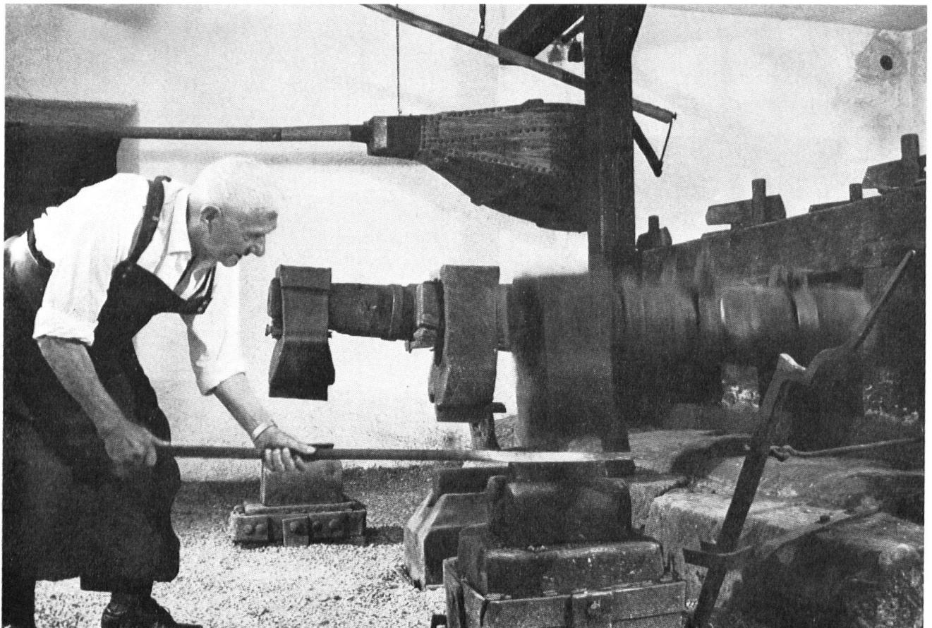
Esse, darüber liegt ein Holzarm, mit dessen Hilfe die schweren Eisenstücke zum Schraubstock, zum Gesenktafel oder zum Hammerwerk befördert werden.
