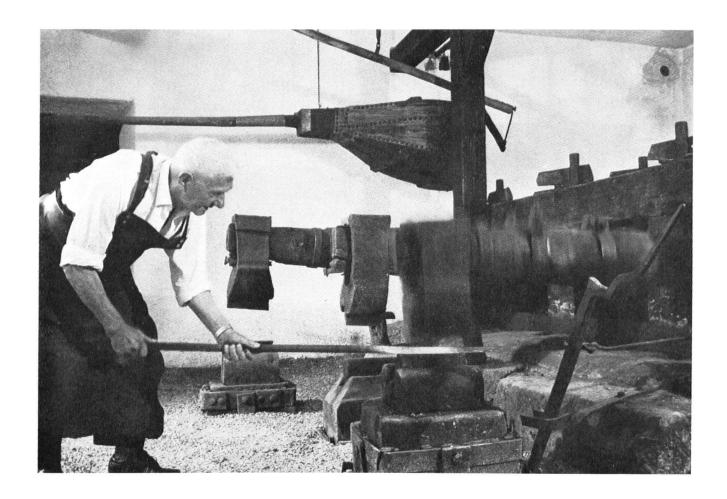
Esse, darüber liegt ein Holzarm, mit dessen Hilfe die schweren Eisenstücke zum Schraubstock, zum Gesenktisch oder zum Hammerwerk befördert werden.
