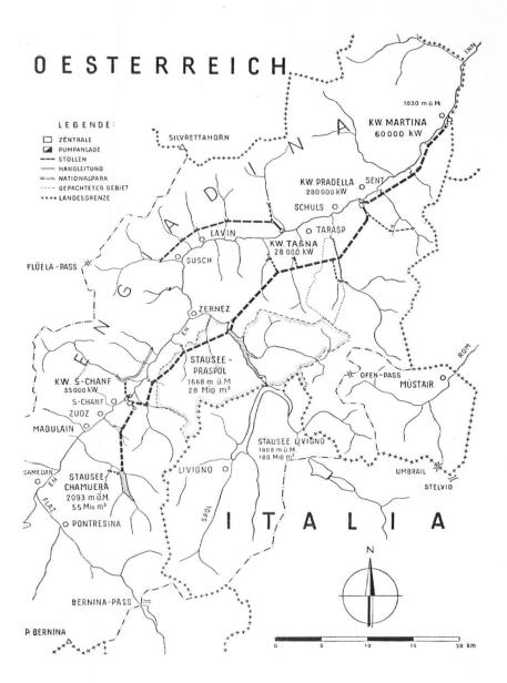
Exploitation des forces hydrauliques sur le plan cantonal: projet 1955 des Entreprises engadinoises comportant, dans le Parc National, le lac de Praspöl (28 millions de m³, conçu par l'ingénieur de Salis en 1919).
