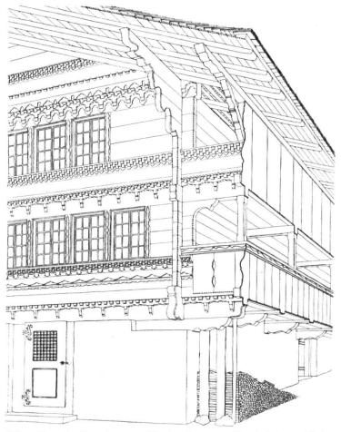
Abb. 5. Haus Schilt in Aegerten. Man beachte, was an Konstruktion und Dekor an dieser vorbildlichen Holzarchitektur zu Tage trift. — Fig. 5. Maison Schilt, à Aegerten. Architecture en bois d'un excellent modèle. Remarquer la décoration et les défails de construction, qui sont apparents du dehors.
