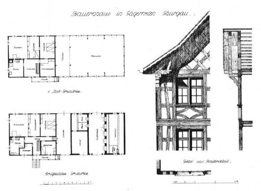
Abb. 13. Grundriss und Einzelheiten zum Bauernhaus in Tägerwilen. Fig. 13. Coupe et plans de détails de la maison de paysan à Tägerwilen.
