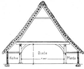
Abb. 6. Nördliches Dachhaus. Der \*Bock\* trägt das Dachgerippe. Aus: Fiedler, Das Fachwerkhaus. — Fig. 6. Toiture d'une maison des régions du nord. La charpente repose directement sur les madriers d'appui. Extrait de Fiedler: La construction en pans de bois.
