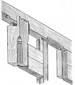
Abb. 2. Schwebender Zapfen (aus Gladbachs \*Holzarchitektur der Schweiz\*). — Fig. 2. Mortaise (gravure extraite de Gladbach : L'architecture en bois, en Suisse)
