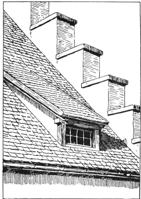
Abb. 6. Das Dachlicht im Ziegeldach. — Fig. 6. Lucarne d'un toit de tuiles.
