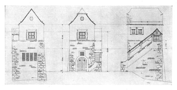
Abb. 7. Schalthäuschen auf der Linie Bevers-Schuls-Tarasp. Gefälliger Bau mit bodenständiger Durchführung aller Einzelformen, z. B. der Fenster, des Portals, des Aufganges und des Daches. — Fig. 7. Poste du service d'électricité sur la ligne Bevers-Schuls-Tarasp. Construction plaisante, dont tous les détails sont harmonieusement combinés. Remarquer surtout la fenêtre, l'entrée, l'escalier et le toit.
