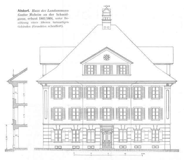
Geometrische Ansicht der Ostfassade mit Schnitt. Masstab 1:150.
