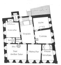
$\begin{array}{c} {\rm Grundrisse\ vom\ Erdgeschoss\ und\ ersten\ Stock.} \\ {\rm Masstab\ 1:300.} \end{array}$
