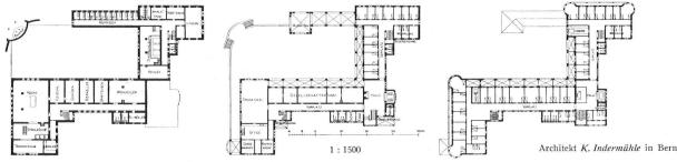
Entwurf für ein Kurhaus, ausgearbeitet im Auftrag der Sektion Bern der S. V. f. H. — Grundrisse vom Keller- und Erdgeschoss sowie vom ersten Stock.
