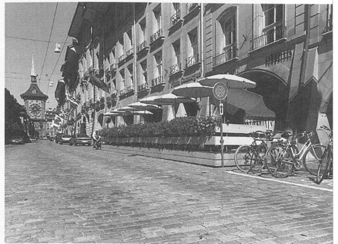
Kramgasse 42: Auf der Gassenpflasterung erstelltes breitgelagertes Podest mit Holzgeländer, das den Laubenbereich über mehrere Fassaden vom Gassenraum abriegelt.
