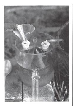
sein d'un essencier appelé également «vase florentin»: le plus souvent l'huile essentielle, de densité inférieure à l'eau, surnage au-dessus de l'hydrolat. Elle est recueillie et mise dans des flacons de verre afin qu'elle se stabilise (réajustement interne entre les diverses molécules); ce repos est indispensable pour qu'elle prenne ses caractéristiques propres avant son utilisation thérapeutique.
