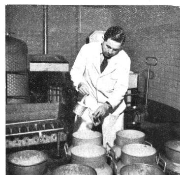
Vor dem Abwiegen der Frischmilch erfolgt zuerst die Beurteilung der Hauptproduzenten. Einige dieser Prüfungen haben fabrikationstechnische Bedeutung, da man auf Grund ihrer Ergebnisse (d. h. Säuregehalt, Fettgehalt usw.) die Fabrikation entsprechend einreguliert.
