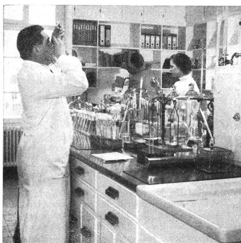
Die Kontroll-Labore in Vuadens sind eine sehr wichtige Abteilung der Firma Guigoz, denn die Produktion aller europäischen Guigoz-Fabriken wird dort laufend untersucht. Diese Zentralstelle kontrolliert einerseits die frische Milch bei der Ablieferung und andererseits jede einzelne Fabrikationsserie. Das Bild zeigt, wie im bakteriologischen Laboratorium das Auszählen der Keime erfolgt.
