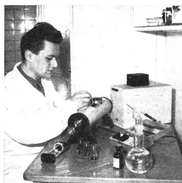
Das Kolorimeter dient zur Bestimmung gewisser Spurenelemente (Eisen und Kupfer) und der wichtigsten Vitamine.
