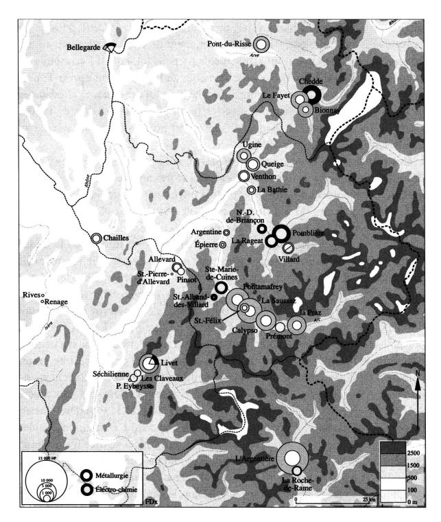
Fig. 3: Principales usines hydrauliques existantes en 1910 dans les Alpes du nord françaises. Les usines sont représentées par des cercles proportionnels à leurs puissances, le cercle intérieur indique la puissance minimum (basses eaux), le cercle extérieur la puissance installée. D'après M. de la Brosse, ingénieur en chef des forces hydrauliques dans les Alpes. Source: d'après Morsel (voir note 3).
