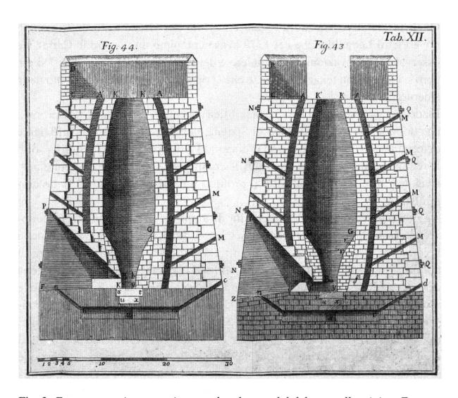
Fig. 2: Forno norvegiano a sezione tonda adottato dal delegato alle miniere Ermenegildo Pini per risparmiare combustibile nel processo di affinazione del ferro. Fonte: Stampa tratta da H. Pini, De venarum metalllicarum excoctione, Mediolani Marelli 1779, vol. I. Biblioteca Nazlonale Braidense, Milano.
