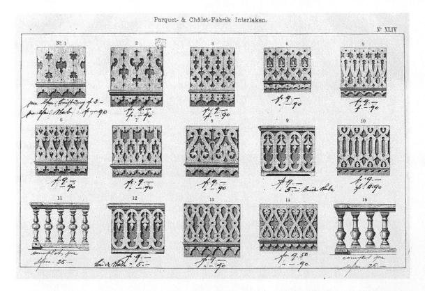
Abb. 3: Muster von Balkonballustraden mit Preisangaben. Quelle: Katalog der «Fabrique de Parquets, Construction de Chalets suisse, Jnterlaken», um 1880, S. XLIV.
