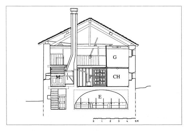
Fig. 3: Eternon-Dessus, Etroubles. Coupe dans une maison en pierre à fonctions concentrées du XIX<sup>e</sup> siècle, avec escalier intérieur. Légende: E: étable; P: chambre commune de séjour; CH: chambre à coucher; M: cuisine; F: fenil avec aire de battage; G: grenier à grains et à pains. Source: Dessin de l'Arch. Danilo Marco.
