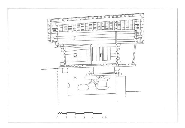
Fig. 6: Construction pionnière de 1430 environ (Laboratoire romand de dendrochronologie). Stoadal de Praz-Dessus (Issime) avec étable à cohabitation. Légende: E: dan goade, étable; F: d'wann et di dilli, fenil avec aire de battage; G: d'stubbu, grenier à grains et à pains. Source: Dessin de l'Arch. Mauro Zucca.
