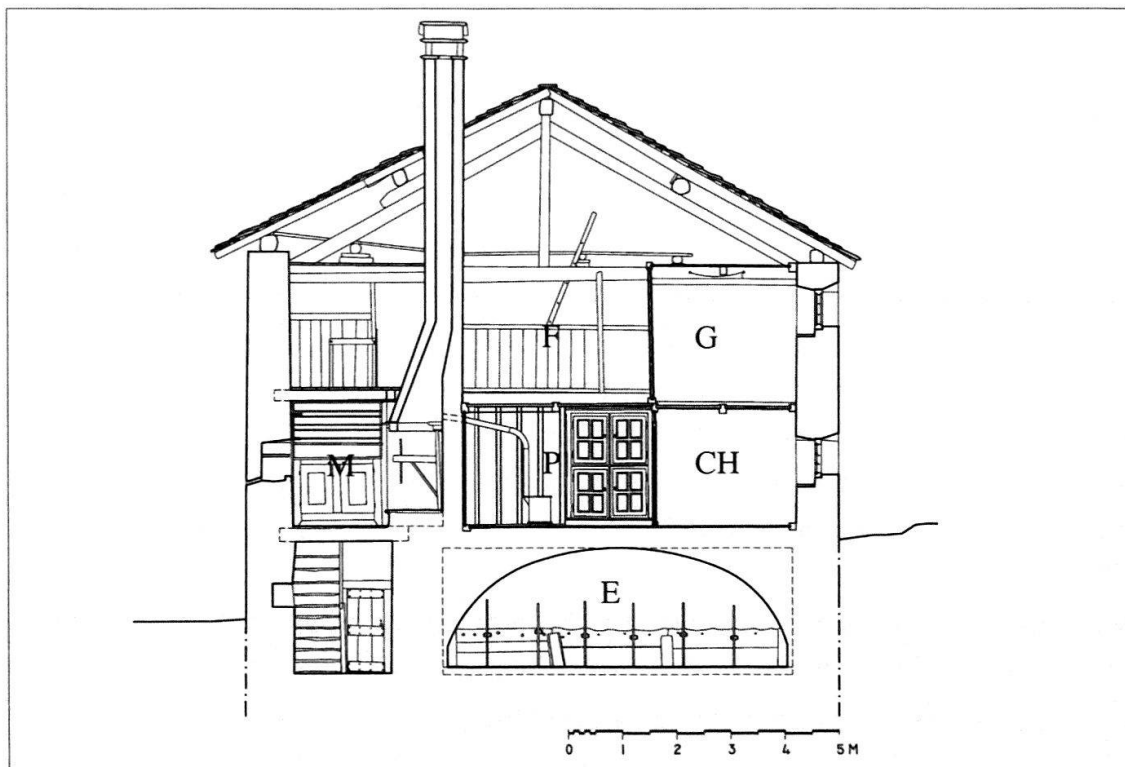
Fig. 3: Etroules, Etroules. Coupe dans une maison en pierre à fonctions concentrées du XIX e siècle, avec escalier intérieur. Légende: E: étable; P: chambre commune de séjour; CH: chambre à coucher; M: cuisine; F: fenil avec aire de battage; G: grenier à grains et à pains. Source: Dessin de l'Arch. Danilo Marco.
