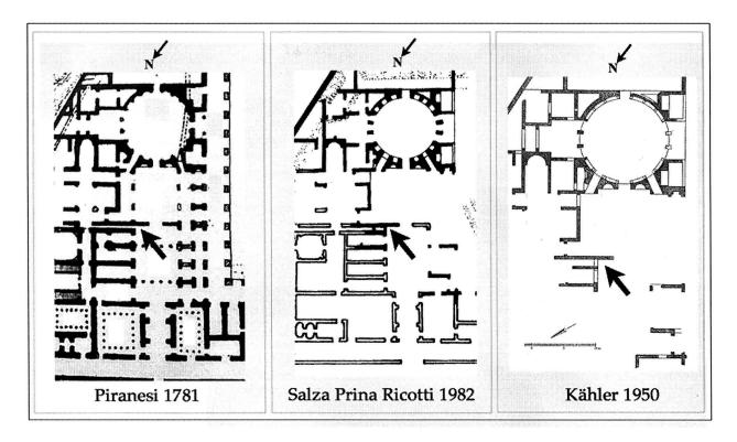
Fig. 4: Tre planimetrie a confronto: la pianta di Piranesi mostra un doppio muro che in realtà non esiste, indicato dalla freccia. La pianta della Salza Prina Ricotti del 1982 ripete l'errore, mente la pianta di Kähler del 1950, frutto di un rilievo più accurato, riporta la situazione reale con un solo muro, come confermato dal nostro rilievo (elaborato da Piranesi 1781 tav. III, Salza Prina Ricotti 1982 tav. V e Kähler 1950 tav. XI).
