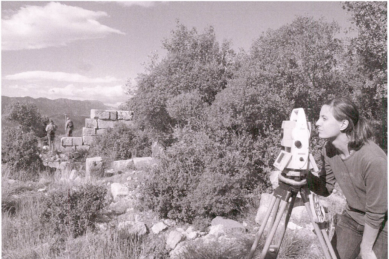
Abb. 4: Aufnahme der Baustrukturen auf dem Uzunoğlan Tepesi mit reflektorloser Tachymetrie und RTK-GPS.
