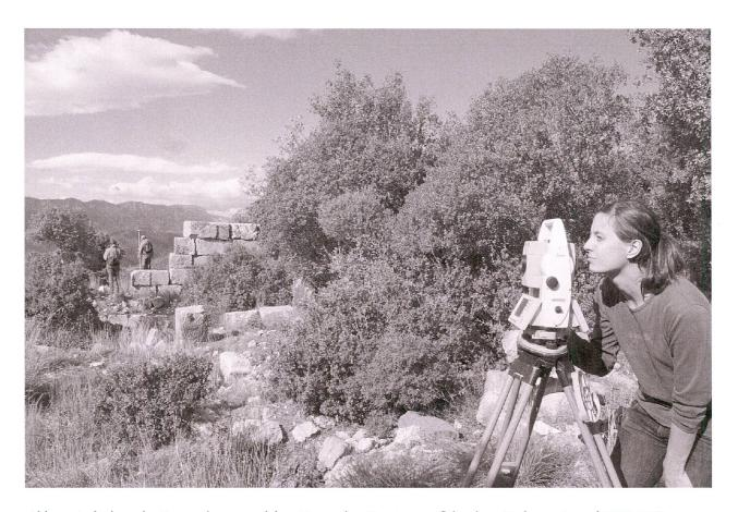
Abb. 4: Aufnahme der Baustrukturen auf dem Uzunoğlan Tepesi mit reflektorloser Tachymetrie und RTK-GPS.
