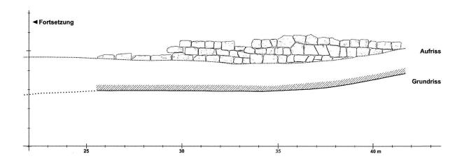
Abb. 3: Amiternum. Bauaufnahme einer Befestigung des Aterno-Ufers aus polygonalem Mauerwerk (zur Lage vgl. Abb. 1 Nr. 11).
