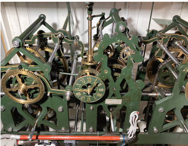
Abb. 3 Faszinierendes Räderwerk! Die Turmuhr von 1938, wurde nachträglich elek- trifiziert und ist seit 2020 computergesteuert.
