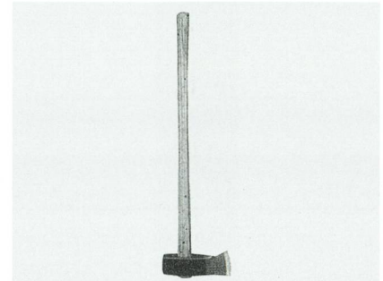
Holzspalthammer, zugleich als Schlegel verwendbar, Gewicht 3,5 bis 4,0 kg mit geradem Stiel von 70 cm Länge.
