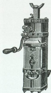
Stockwinde, Berner Handarbeit, mit Kettenhaken, Tragkraft von 1000 bis 5000 kg.
