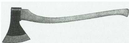
Fällaxt aus Stahl mit Eschenholzstiel.
