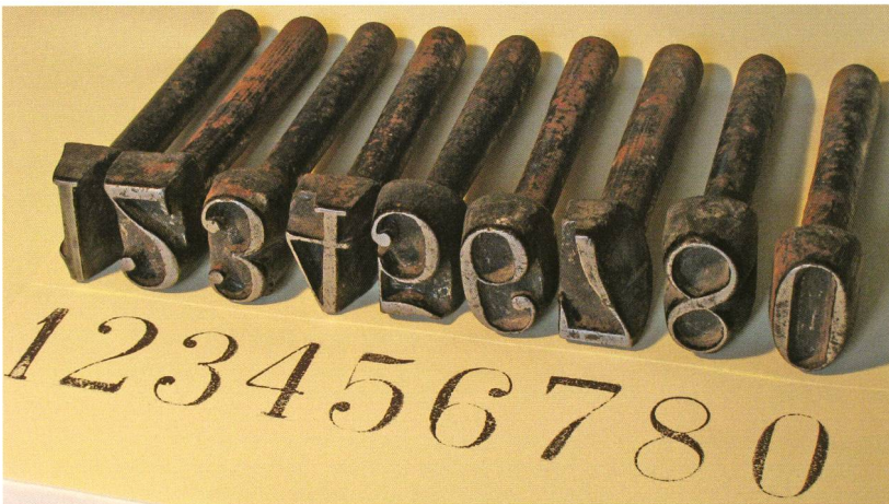
Zahlenstempel-Satz zum Nummerieren der Holzgaben aus dem Besitz von Adolf Flury, Bannwart von 1932 bis 1960. Die neun Stahlguss-Stempel stecken griffbereit in einem Holzkästchen mit Tragriemen. Ein Fach enthält eine zähflüssige schwarze Masse, die Stempelfarbe, vermutlich mit Russ vermengtes Baumharz. Mit dem Holzhammer wurde der eingefärbte Stempel auf das Stirnholz geklopft.
