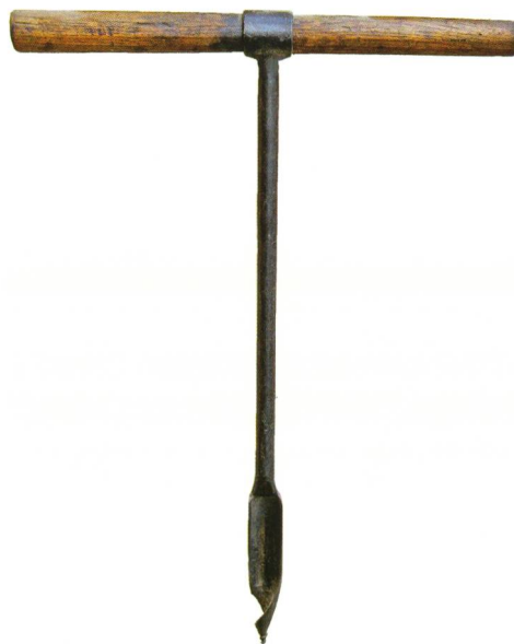
Ausgegrabene Wurzelstöcke wurden mit Schwarzpulver gesprengt. Dazu mussten zuerst Löcher ins Holz gebohrt werden. Holzbohrer, 53 cm
