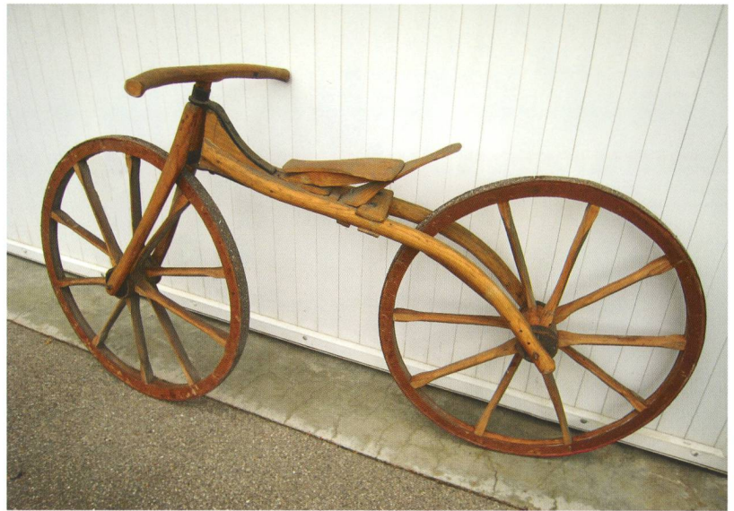
Niederrad aus Holz ohne Tretkurbel. Nachbau von Franz Flury, Wagner.
