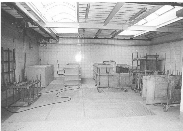
Ablaugerei mit Laugenbad, Neutralisation und diversen Wässerungsbecken.
