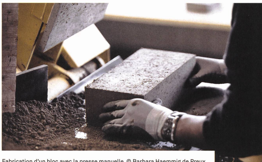
Fabrication d'un bloc avec la presse manuelle. © Barbara Haemmig de Preux
