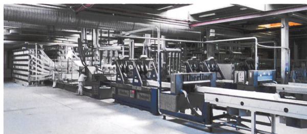
Halle de fabrication de barres en matériaux composites. Pultrusion 1/ DR
