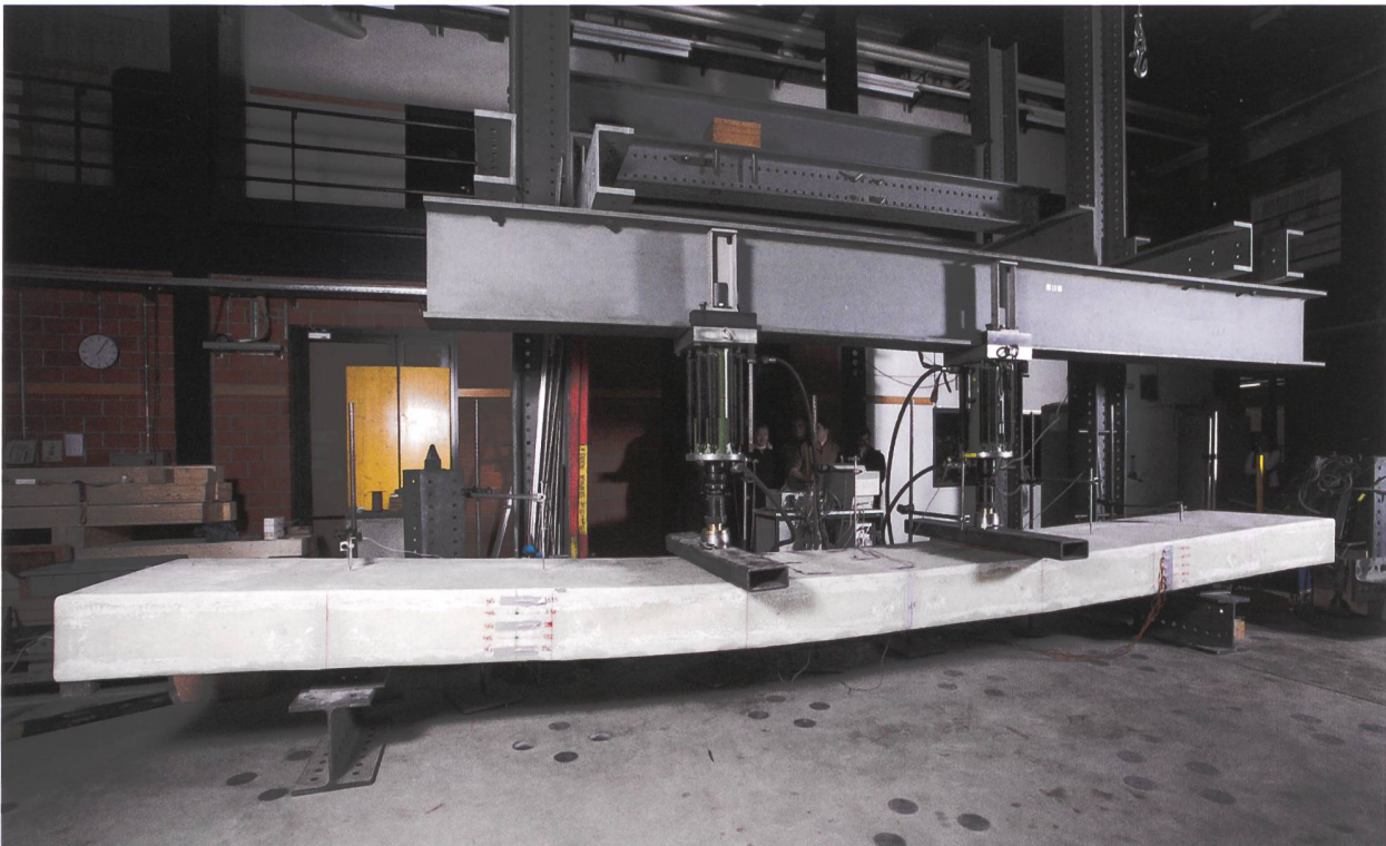
Le CCLAB de l'EPFL est équipé de machines pour effectuer des tests de résistance de barres en matériaux composites.
