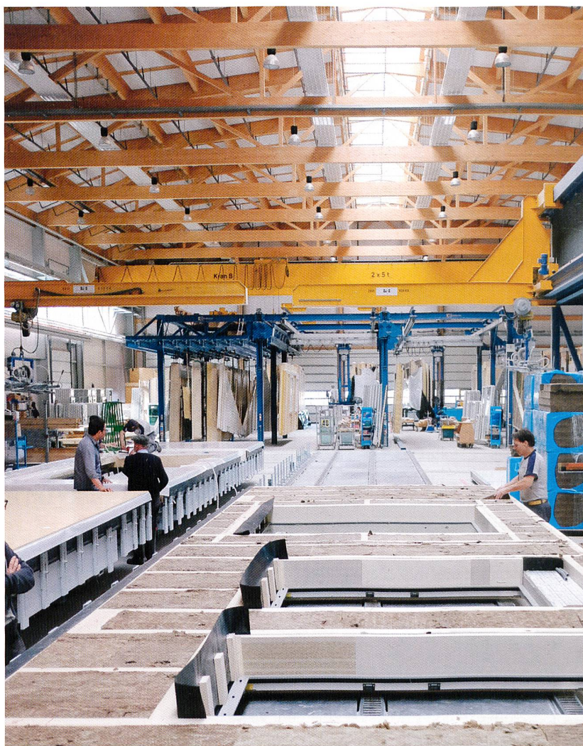
La chaîne de production des éléments préfabriqués. Bellmann/DR
