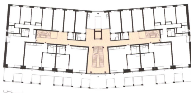
Plan du 1 er étage (g) L'ascenseur ne dessert que les appartements du milieu. L'accès aux autres appartements est possible par les passerelles. Au 3 e étage (d), la «rue intérieure» met en relation l'ascenseur et les cages d'escaliers situées à l'Est et à l'Ouest. DR
