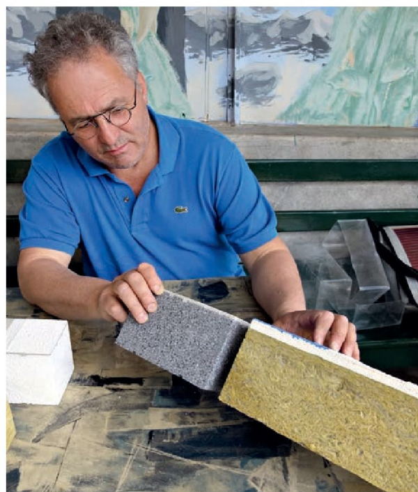
A l'aide de deux échantillons, Jean-François Dedominici compare un système d'isolation organique à couche mince polluant et non durable à gauche et un système à couche épaisse diffusant durable et respectueux de l'environnement. © PC 2014
